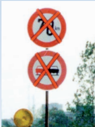
Bild 4: Außer Kraft gesetzte Verkehrsschilder mit Auskreuzvorrichtung (links) bzw. Folienbändern (rechts)
