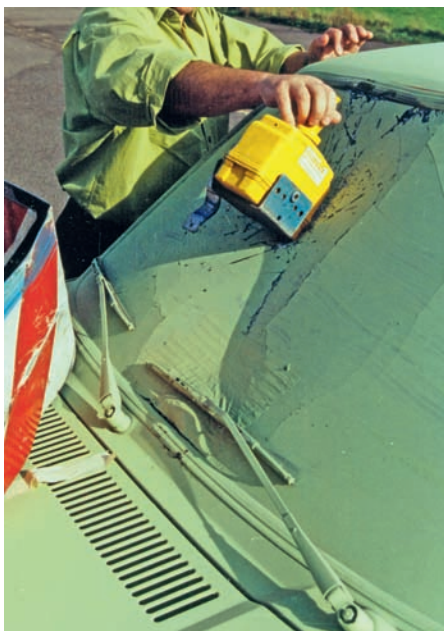
Bild 4: Weggeschleuderte Kombiwarnleuchte bei BAST-Versuch
