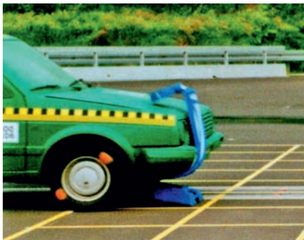
Bild 2: Beispiele für geprüfte Leitbakensysteme mit Warnleuchten/Batteriekombinationen
