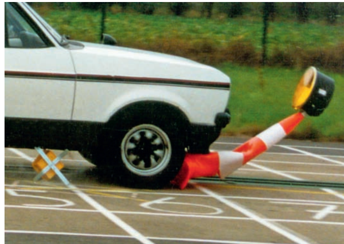
Bild 9: Leitkegel mit aufgesetzter Warnleuchte
