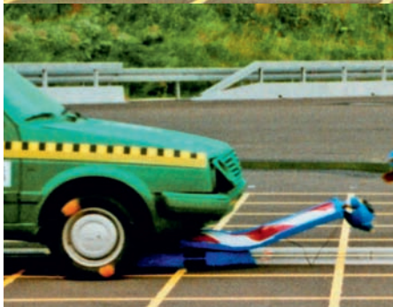
Bild 3: Fahrzeuganprall bei einer Leitbakenprüfung
