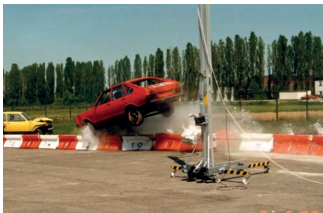
Bild 3: Anprallversuch an einer mit Wasser gefüllten Leitwand aus Kunststoffkästen
